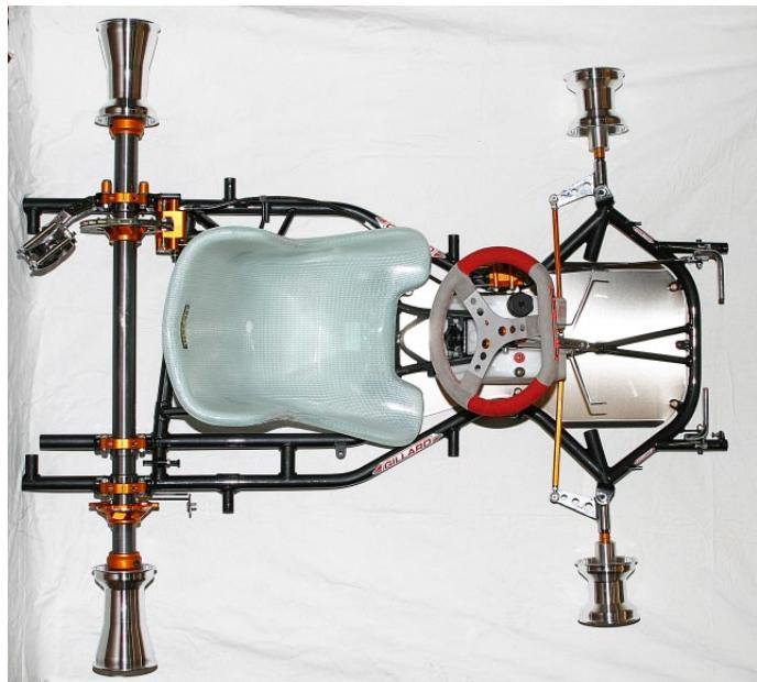
**PHOTO VUE DE DESSUS DU CHÂSSIS COMPLET IDENTIQUE À L'UN DES MODÈLES PRÉSENTÉS À L'HOMOLOGATION SANS PARE-CHOCS, CARROSSERIE NI PNEUMATIQUES**
