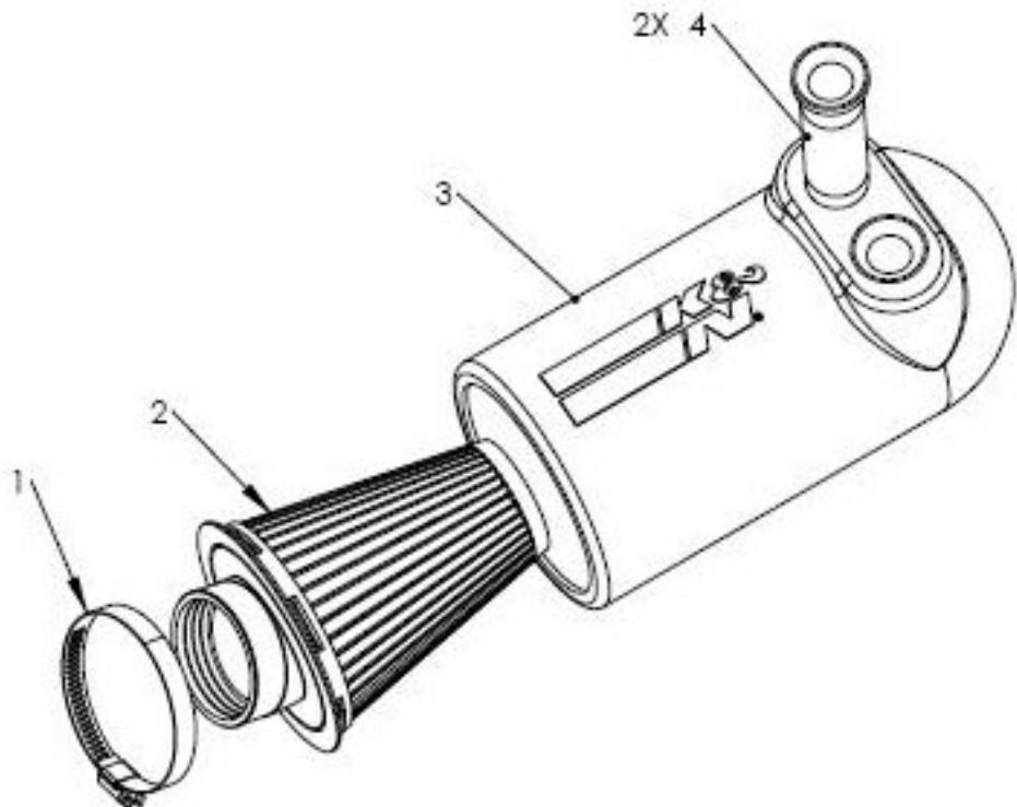
**Le dessin technique explosé doit montrer : Eléments du silencieux, éléments acoustiques absorbants, éléments filtrants, tubes d'aspiration et manchon de fixation au carburateur.**
